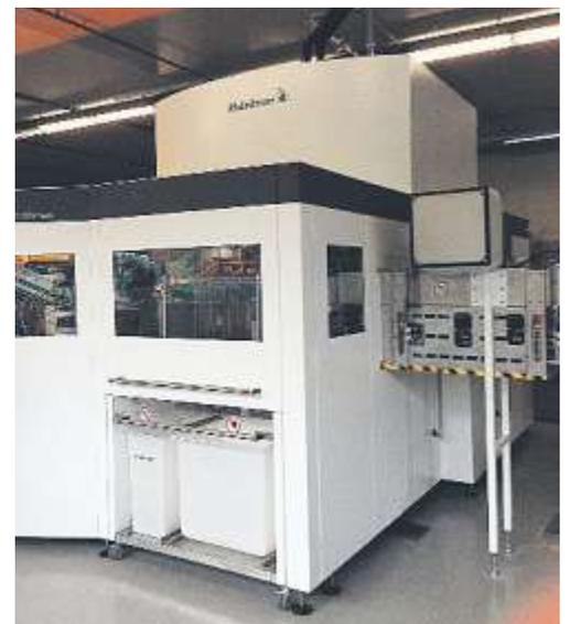
Die neue Streckblasmaschine in Rhäzüns.
